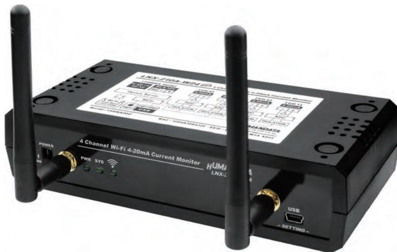
LNX-210A-W24は、Wi-Fi経由で4チャンネルの4-20mA信号を測定できる電流モニタです。各チャンネル間はそれぞれ独立して絶縁されています。チャンネル毎にADコンバータを搭載しており4チャンネル同時測定が可能です。
