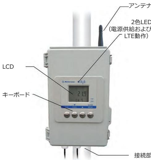
データロガーは、SMSメッセージでコマンドを送ることによって、または、モバイル（携帯電話）ネットワークで、インターネット接続されている遠隔のPCとの直接TCP/IP接続を設定することによって、遠隔での管理が可能です。
